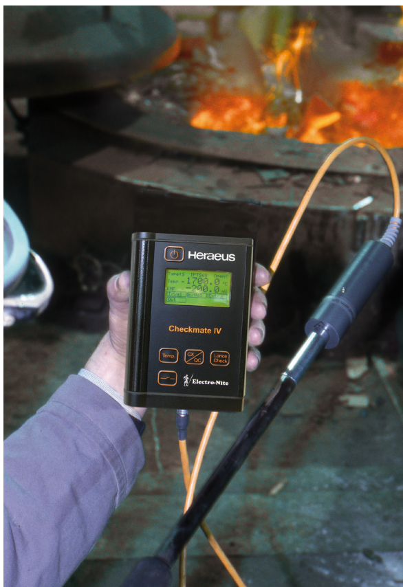
Funktionstest mit einer Tauchmesslanze
